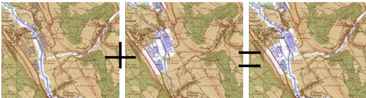
Figure 1 : fusion des différents buffers liés à l'hydrographie créés à partir de la BD CARTHAGE
